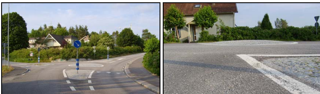
Abb. 22 Minikreisverkehre mit überfahrbaren Mittelinseln (Schweden)
